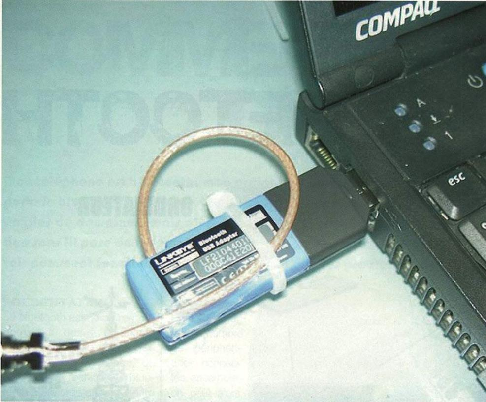
Module bluetooth en USB avec antenne, le must du pirate.
